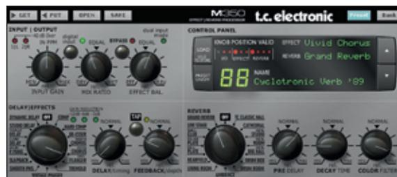
Mediante el software de edición incluido, es posible automatizar o controlar en tiempo real los ajustes de parámetros y la activación de presets.
