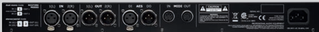
Modalità Routing Ingressi Analogici Bilanciati XLR Uscite Analogiche Bilanciate XLR In/Out digitale AES/EBU MIDI I/O Ingresso Power. La modalità switch dell'alimentazione interna accetta voltaggi compresi tra 100 e 240 VAC
