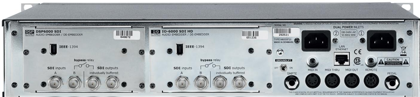
DB4 MKII und DB8 MKII sind mit derselben Stromversorgung ausgestattet wie die ursprünglichen Geräte – dies aber gleich in doppelter Ausführung. Dasselbe gilt für Sicherungen, Netzeingänge und sogar die in der Schweiz gefertigten Papst-Lüfter. Die Abbildung zeigt die Dual-SDI-Konfiguration; ebenso sind symmetrische AES- und asymmetrische AES3-id-Konfigurationen verfügbar.
