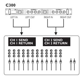
Dans cet exemple le C300 est utilisé en mode Dual mono avec 2 engines indépendants et 100%mono, sur deux canaux séparés- Chacun des deux engines n'a aucune influence sur l'autre.
