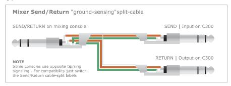
Type 1 et Type 2 sont adaptés aux situations où le C300 est utilisé en insert de canal sur des consoles de mixage équipées de points d'inserts asymétriques sur jack 1/4" stéreos.
