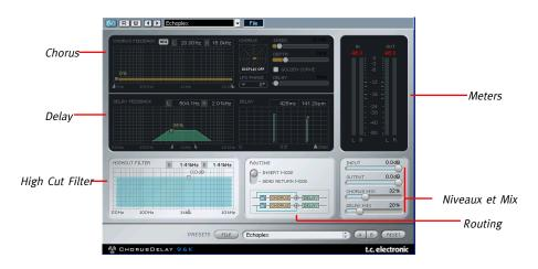
l'algorithme CHORUS est un algorithme de modulation très puissant. Il incorpore une ligne de délai, une section LFO logique et deux filtres individuels de feedback vous permettant de produire des effets de feedback très interessants, allant du simple chorus aux effets étincelants dans des espaces sonores élargis.
