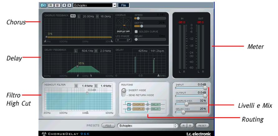
CHORUS™ è un algoritmo di modulazione molto potente. Incorpora una linea di delay, una sezione LFO completa e due filtri feedback, che permettono di creare effetti feedback molto interessanti, spaziando dal chorus più semplice fino agli effetti più estremi e accattivanti!
