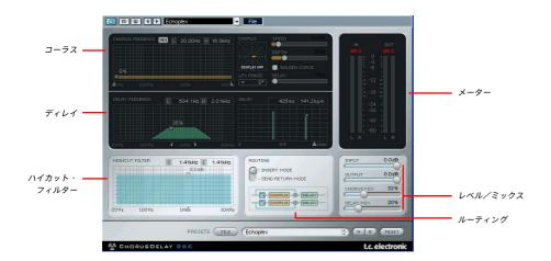
コーラス・アルゴリズムは極めてパワフルなモジュレーション・アルゴリズムで、ディレイ・ライン/充実したLFOセクション/2系統のフィードバック・フィルターから構成されています。シンプルなコーラスから宇宙の彼方のきらめきまで、幅広いフィードバック・エフェクトを作ることができます。
