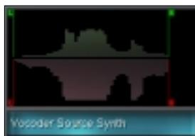
La metà superiore del display mostra la banda Analysis, quella inferiore le impostazioni per i filtri del Vocoder. Cliccando sulle maniglie "L" o "H", potete spostare i parametri direttamente sul display.
