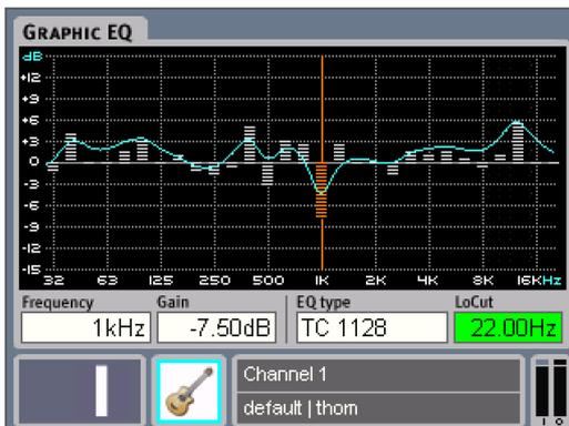
Il Graphic EQ è un equalizzatore grafico a 29 bande (1/3-ottava), con una gamma compresa tra 31Hz e 20kHz ed un gain range di +/-12dB.
