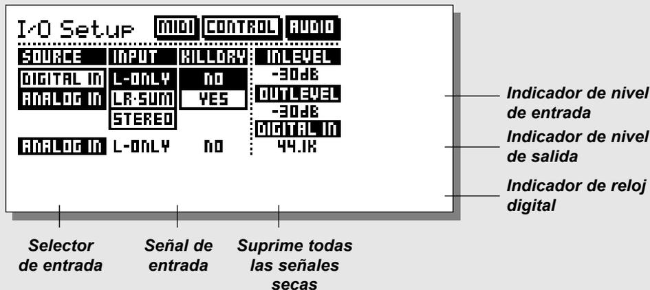
Los parámetros de este ajuste de entrada/salida contienen ajustes de todas las conexiones exteriores del G-Force: - MIDI, Pedal y audio digital y analógico.
