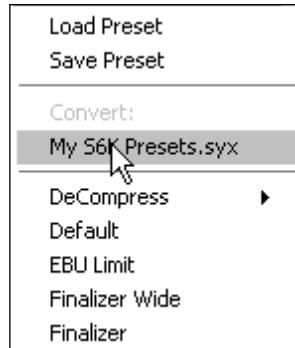
プリセット・ファイルを Unwrap プリセットにコンバートするには、プリセット・ファイルを選択します。コンバートを必要とするのは一度のみで、変換は数秒で完了します。
