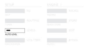
Affectez le signal source à une entrée du M2000 et appuyez sur la touche Auto Level (Shift-Levels), le niveau d'entrée est alors réglé automatiquement au niveau optimal. Le M2000 laisse jouer une mesure et règle ensuite le niveau d'entrée à environ 6 dB de la réserve dynamique maximale.
