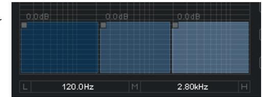
Die Mindestbreite eines Bandes beträgt zwei Oktaven. Um die Anhebung oder Absenkung für ein Band einzustellen, klicken Sie auf einen der drei Blöcke und bewegen die Maus bei gedrückt gehaltener Maustaste in vertikaler Richtung. Die genaue Anhebung wird numerisch direkt über dem Block angezeigt.
