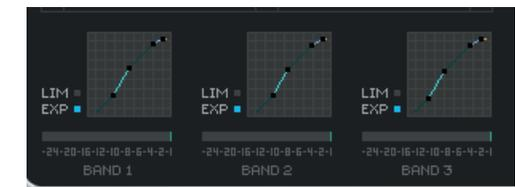
Die »Leuchtdioden« unter der Anzeige zeigen, ob der Expander oder Limiter eines Frequenzbandes aktiv ist. Die Pegelabsenkungsanzeige zeigen, wie stark der Signalpegel durch den Kompressor gerade vermindert wird.
