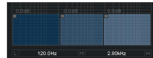
L'ampiezza minima di ogni banda di frequenza è 2 ottave. Ogni guadagno è regolabile cliccando su uno dei tre blocchi e contemporaneamente muovendo il mouse in alto o in basso; il valore numerico esatto del guadagno è visualizzato al di sopra di ogni blocco.
