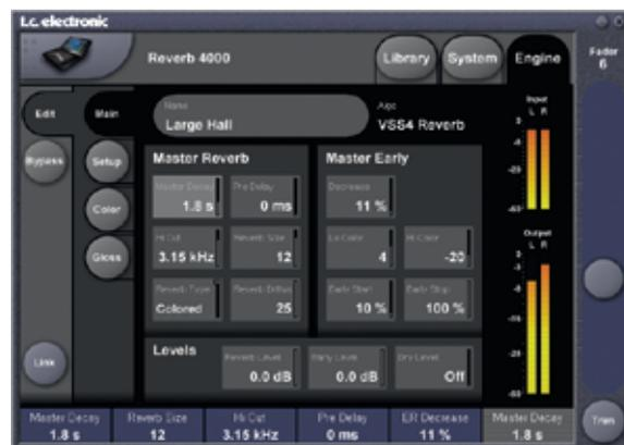
Mit Hilfe des im Lieferumfang enthaltenen Software-Editors TC Icon können Sie das Reverb 4000 via USB von einem Computer (Macintosh oder PC) aus steuern und überwachen.
