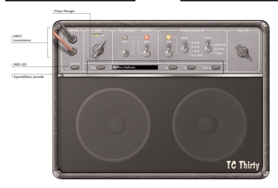
la sezione SETUP di TC Thirty permette di definire il comportamento generale del Plug-In. Premendo il tasto SETUP, apparirà una finestra di dialogo pop-up comprendente alcuni controlli generali e le relative impostazioni. Questi parametri non fanno parte del Preset caricato: i parametri Speaker Animation e Visibility sono di tipo "globale", validi per ogni TC Thirty aperto dopo aver effettuato una qualsiasi modifica. I parametri MIDI saranno salvati insieme alla sessione di lavoro.
