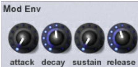
Esto es un generador de envolvente de 4 fases que puede usar para una amplia gama de barridos del filtro. Use este MOD ENV para sonidos de bajo sintetizado, barridos de volumen lentos, ataques de tipo metales y otros. También puede usar esta envolvente de modulación para afectar al tono y a la amplitud del pulso de las formas de onda de los tres osciladores.
