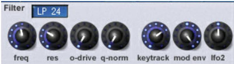
El filtro pasabajos del V-Station es el corazón de la tecnología 'analógica líquida' de Novation al modelar con total precisión las características tonales exclusivas de un filtro analógico 'real'. Puede realizar un barrido de este filtro con su propio generador de envolvente o con el LFO2. La gama de la resonancia es muy amplia cubriendo desde 'nada' a extrema y para disponer de una gama aun mayor, el control O-DRIVE le permite añadir distorsión.
