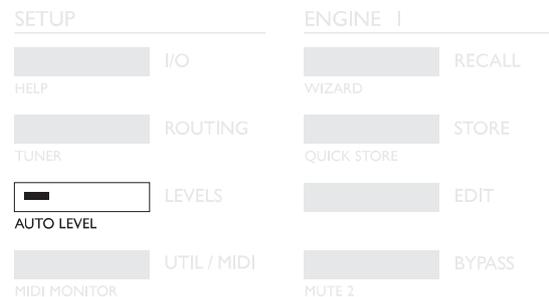
Invia il segnale audio a M2000 e attiva l'Auto Level (Shift-Levels) per ottimizzare automaticamente il livello d'ingresso del segnale. M2000 impiegherà circa cinque secondi per misurare il segnale audio, quindi regolerà l'Input Level impostando 6 dB di Headroom.
